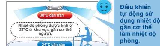
Cảm biến được nhiệt độ sàn thấp hơn
